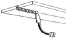
Рисунок 23. Сварка в потолочном положении
