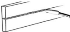
Рисунок 22. Сварка в горизонтальном положении
