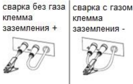
Рисунок 16. Полярность при полуавтоматической сварке
