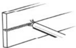
Рисунок 13. Горизонтальное положение при сварке
