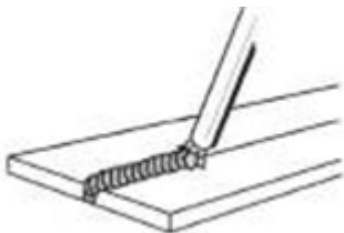
Рисунок 12. Нижнее положение при сварке
