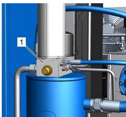
Рис. 20: Клапан минимального давления/обратный клапан
