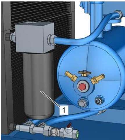
Рис. 41: Демонтаж фильтра охлаждающей жидкости
