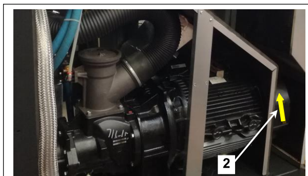
Направление вращения с фиксированной скоростью и VSD.
